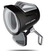
带日行灯和喇叭功能,透镜式配光,搭配高功率 LED 光源,采用了铝外壳散热,避免元件过热以及 LED 的光衰问题。安装支架通过 72 小时盐雾测试,固定方式简便、可靠,角度可调节,可搭配多种车型。
